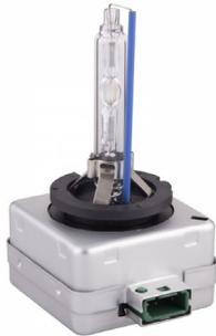
Ксеноновые штатные (оригинальные) лампы **MLux** серии **QUARTZ** с цоколем D3S (PK32d-5) экологически безопасны, т.к. ртуть заменена неядовитым йодидом цинка, соответствуют стандарту UN ECE R.99 и успешно сертифицированы после 14 месяцев разработки и испытаний.
