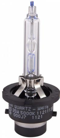
Ксеноновые штатные (оригинальные) лампы **MLux** серии **QUARTZ** с цоколем D4S (P32d-5) экологически безопасны, т.к. ртуть заменена неядовитым йодидом цинка, соответствуют стандарту UN ECE R.99 и успешно сертифицированы после 14 месяцев разработки и испытаний.
